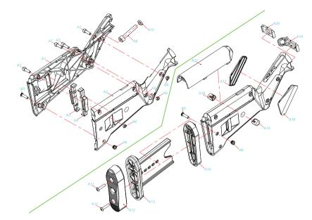
A1 **BODY LEFT** A2 **BODY RIGHT** SLING POINT LEFT A3 Α4 SLING POINT RIGHT Α5 DOWN FIX SCREW A6 DOWN FIX NUT Α7 **BODY FIX SCREW** Α8 BODY FIX NUT Α9 STOCK BOLT SCREW A10 STOCK BOLT WASHER
